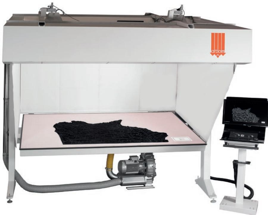
Die **Intelliview-Modelle** sind als integrierte und eigenständige Systeme erhältlich und erfassen automatisch die Kontur aller Lederarten und -farben. Durch die Beleuchtung ist eine deutliche Visualisierung der Oberfläche möglich, sodass die Inspektion des Leders erleichtert wird.
