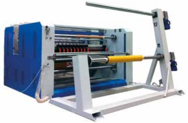
KK1 Zweiter Kaschierkopf mit Längs- und Querschnitt Zweifache Aufwicklung
