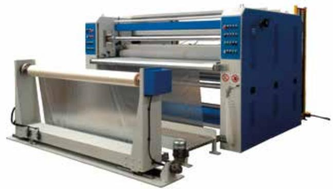
K1-LG Laminiersystem mit Längs- und Querschnitt
