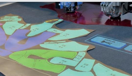
Hochleuchtkraftprojektoren sorgen für eine genaue Abbildung der zu schneidenden Kontur auf allen Materialien oder Farben unabhängig von der Umgebung.
