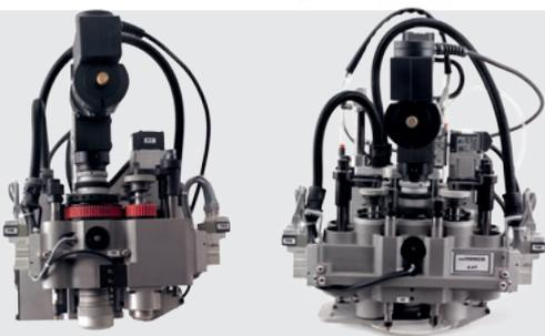
Um jeden Schneidprozess optimal ausführen zu können, verfügen die Easy-Tische über Werkzeugköpfe mit 5 oder 7 Werkzeugen für verschiedene Messerköpfe, Markierungsstifte und 2 oder 4 Lochpfeifen. Mit dem leistungsstarken Absaugsystem kann der Lochpfeifenabfall ganz einfach abgesaugt werden.
