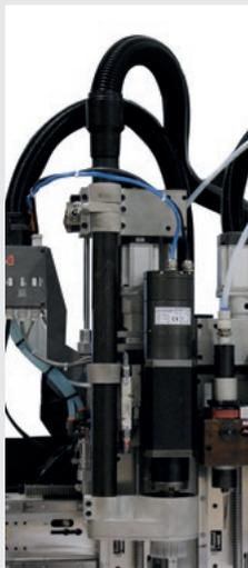
Die HD-Modelle wurden speziell dafür entwickelt, Schaumstoff und Well- oder Wabenpappe zu schneiden; sie können Materialien bis zu 130 mm Stärke schneiden und verbinden. Schneiden, Falzen und das Schrägschneiden im 45°-Winkel.
